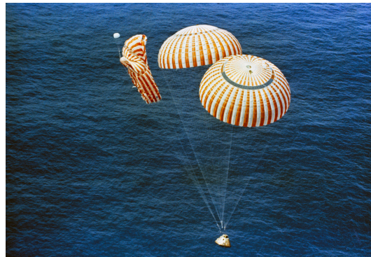
Abbildung 3: Die Kapsel der Apollo 15-Mission wassert mit nur zwei intakten Fallschirmen (Bild: NASA)
