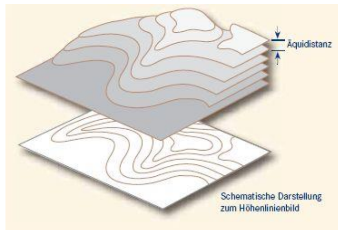
Abbildung 7: Schematische Darstellung zur Erzeugung der Höhenlinien in einer Karte ( Geoline , Bayerische Vermessungsverwaltung).
